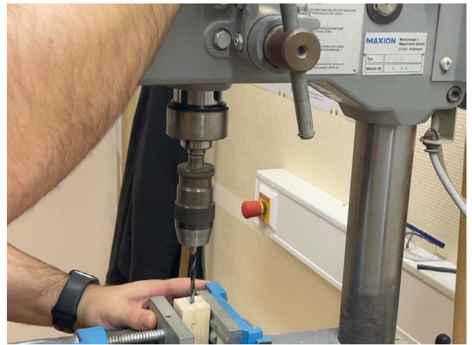
Abbildung 14: Bohren des Kabelschachts
