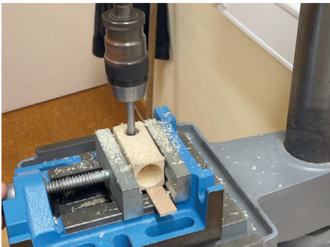
Abbildung 13: Bohren des Mastenschachts
