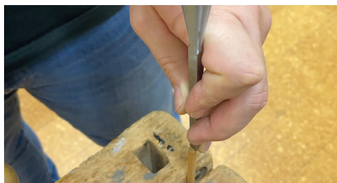
Abbildung 32: Schlagen der Kerbungen mit einem Stechisen
