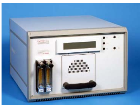
Figura 3.4. Plasma Asher modelo K1050X (Hemitech, Kent UK)
