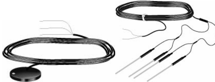
Figura 2.8. Placa de flujo de calor al suelo (HFT3) y termopares (TCAV)
