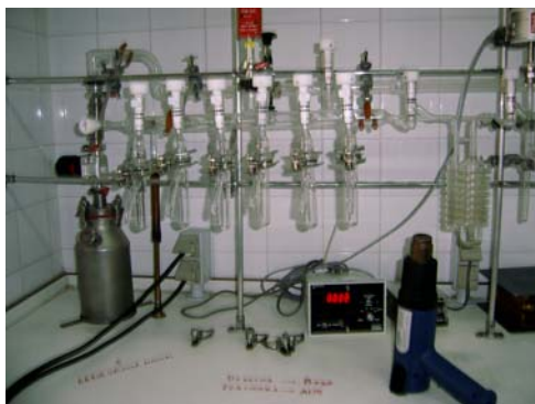
Figura 3.5. Tubos de reacción conectados a la línea de carbonatos y pistola de aire caliente
