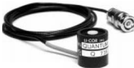
Figura 2.9. Sensor de radiación fotosintéticamente activa (Li-190)
