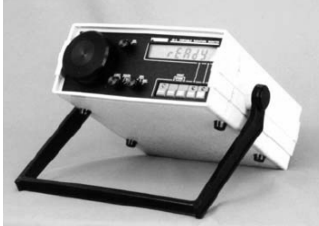
Figura 2.12. Sensor para la medida de concentración de Radón (modelo Pylon AB-5)
