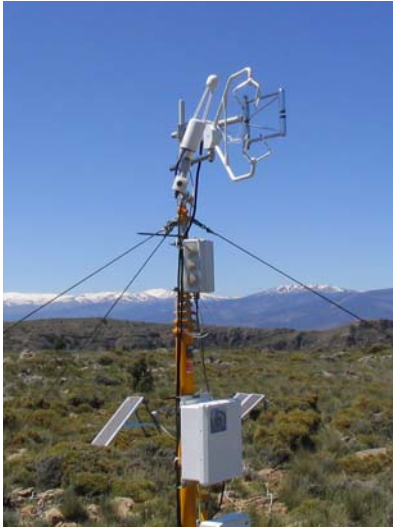
Figura 4.8. Torre de eddy covariance instalada en el Llano de los Juanes. El instrumento localizado a la izquierda de la foto en el analizador de gases por infrarrojo, el instrumento del centro es el anemómetro sónico y el de la derecha es el higrómetro Krypton.
