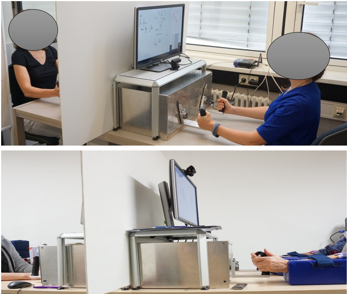
Abbildung 8: Aufbau des experimentellen Gesamtsystems Bi-Manu-Interact der Technischen Universität Berlin (Ivanova et al., 2019)
