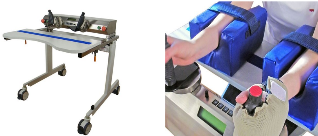
Abbildung 6: Links - Bi-Manu-Track - robotergestütztes Therapiegerät der Firma Reha Stim | Rechts - Lagerungskissen mit Armmulde und Hand-Schleufe. ©RehaStim
