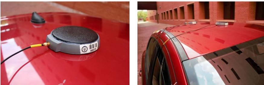
Figura 4. Antenas gemelas situadas en el techo del vehículo.
