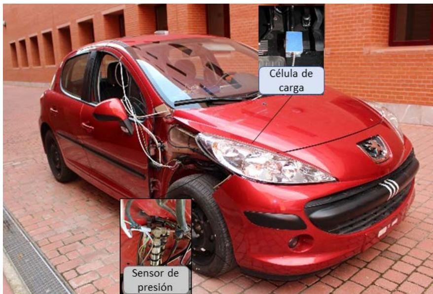
Figura 1. Vehículo instrumentado Peugeot 207 1.6 HDI 16 v.
