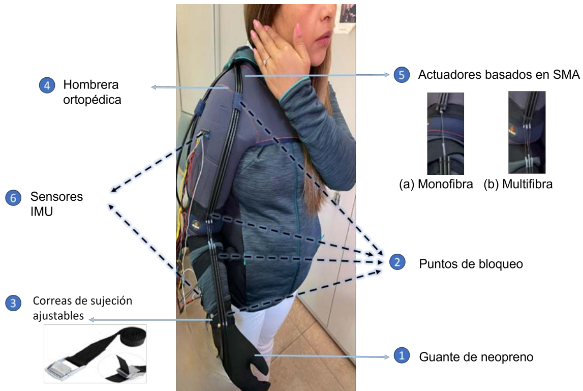
Figura 7.2: Exo-traje propuesto: 1 - Guante de neopreno; 2 - puntos de bloqueo para los actuadores basados en SMA; 3 - correas de sujeción ajustables; 4 - hombrera ortopédica; 5 - actuadores de SMA (a) monofibra y (b) multifibra; 6 - sensores IMU.
