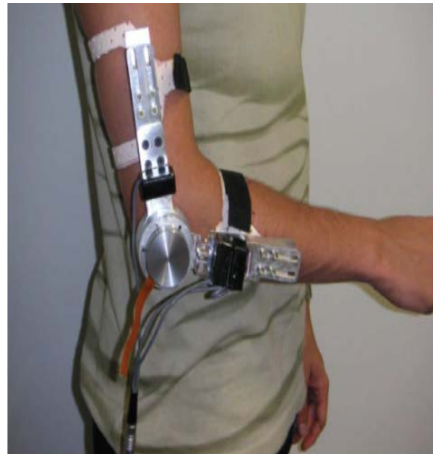
Figura 2.5: Prototipo de WOTAS para la articulación del codo, activado por un motor CC del proyecto DRIFTS [15].
