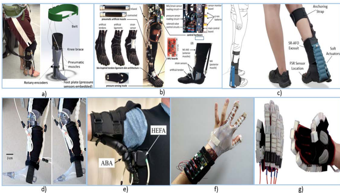
Figura 2.2: a) Órtesis robótica para la articulación del tobillo[1]. b) Dispositivo robótico vestible para rehabilitación del miembro inferior (tobillo y pie) [2]. c) Exosuit robótico blando de tobillo-pie SR-AFO con actuación neumática [3]. d) Prototipo en funcionamiento extensión y flexión de la rodilla [4]. e) Actuador neumático para asistir el movimiento de la parte superior del brazo [5]. f) Guante con actuador neumático blando SPA [6]. g) Guante neumático para la rehabilitación de la mano [7].
