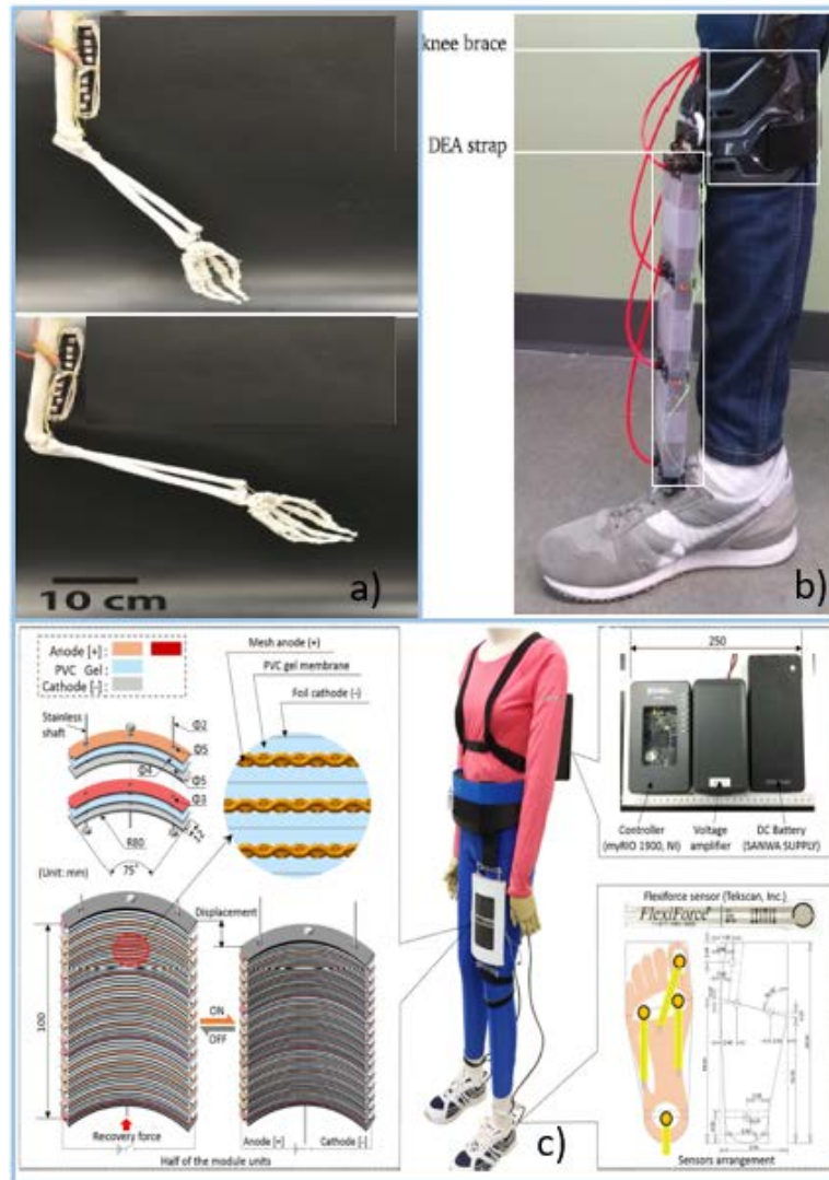
Figura 2.4: a) DEA para rehabilitación para la articulación del codo [12]. b) Prototipo de AFO basado en DEA [13]. c) Prototipo de la prenda de asistencia a la marcha basada en el gel de PVC [14]
