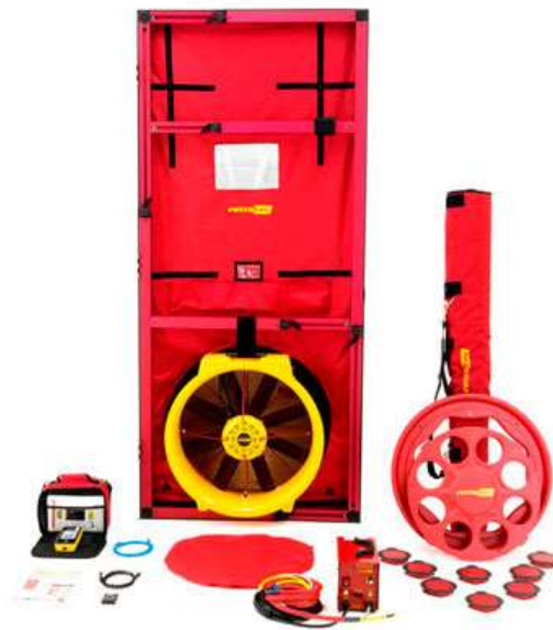
Fig. 37. Blower door test. Fuente: (Passivhaus-Spain, 2023)
