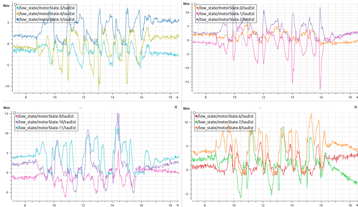
Figura 6.30: Visualización de los pares articulares de cada articulación en el robot real. De izquierda a derecha y de arriba a abajo: Pata delantera izquierda, pata delantera derecha, pata trasera izquierda y pata trasera derecha. En cada gráfica de arriba a abajo en la leyenda: posiciones de la cadera, muslo y tobillo
