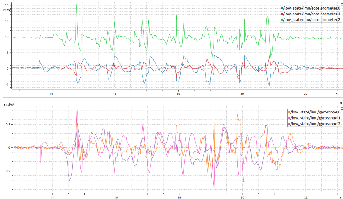
Figura 6.29: Visualización de las aceleraciones lineales y angulares tridimensionales del robot real. En la parte superior se observa la aceleración lineal y en la inferior la angular.
