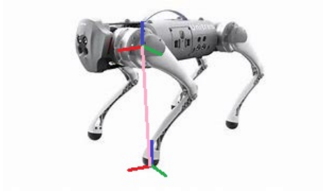
Figura 4.7: Cambio del sistema de coordenadas al muslo con q_1=0
