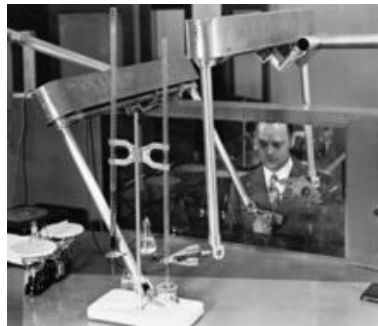
Figura 2.1: Primer manipulador maestro-esclavo (Emmanuel Nuño Ortega, 2004)
