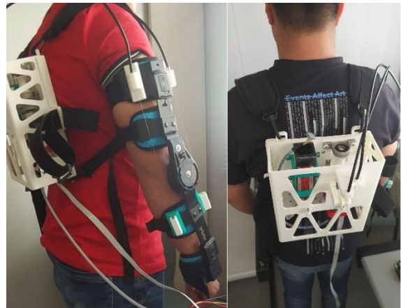
Figura 6. Exo-traje puesto sobre un usuario sano
