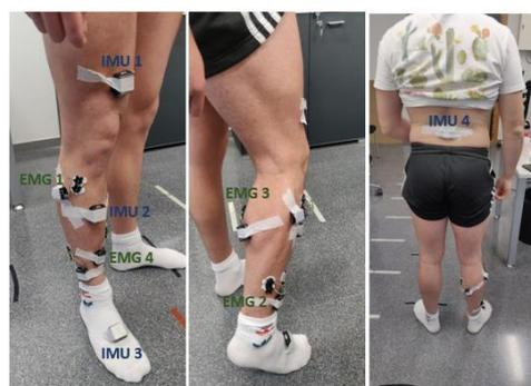
Figura 1: Distribución de los sensores inerciales y EMG en el cuerpo
