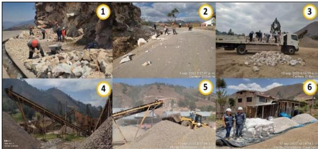
*Nota.* (1) Extracción manual, (2) voladura controlada, (3) transporte de material, (4) y (5) proceso de chancado y (6) almacenaje de agregado.
