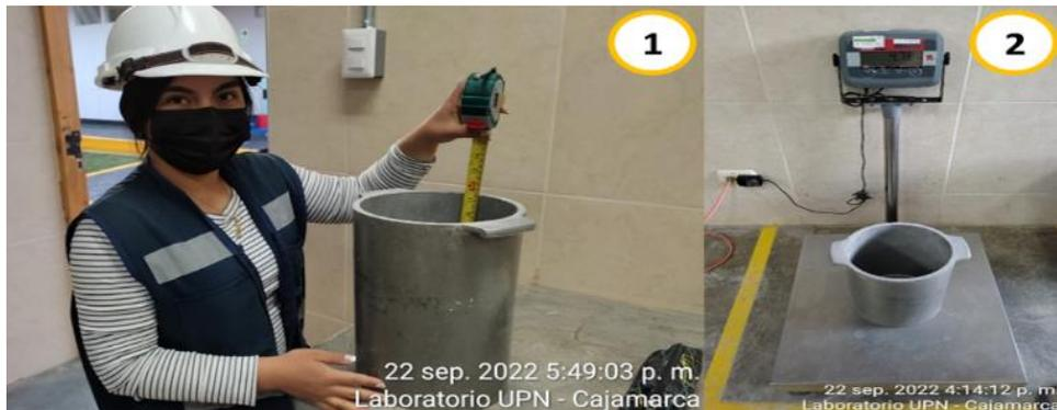
*Nota:* Para este ensayo ya sea para agregado grueso o fino es necesario: (1) Registrar los datos de altura y diámetro del recipiente cilíndrico (2) Determinar el peso del recipiente.
