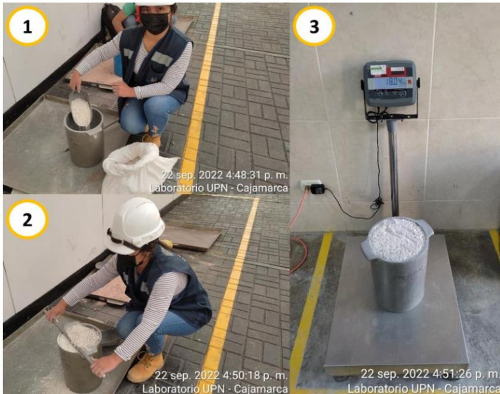
*Nota:* (1) Previamente secar la muestra a temperatura constante y determinar el peso del recipiente cilíndrico de metal con asas, además de medir la altura y diámetro (En nuestro caso tenemos el peso del recipiente del ensayo anterior). Llenar el recipiente con la ayuda de un cucharón, hasta el rebose (unos 5 cm por encima del borde del recipiente). (2) Luego enrasar con la varilla de apisonado. (3) Determinar y registrar el peso del recipiente más la muestra.
