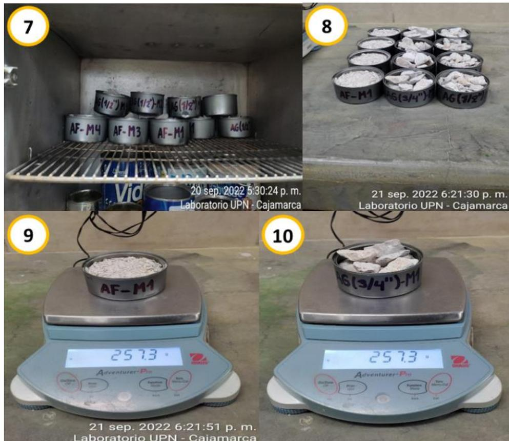
*Nota:* (6) Todas las muestras fueron colocadas en el horno a temperatura constante por 24 h. (7) Muestras en el horno. (8) Muestras luego de 24 h en el horno. (9) Se registró el peso de las muestras, en la fotografía se aprecia el Agregado Fino- Muestra 1. (10) Fotografía del Agregado Grueso (3/4'') - Muestra 1.
