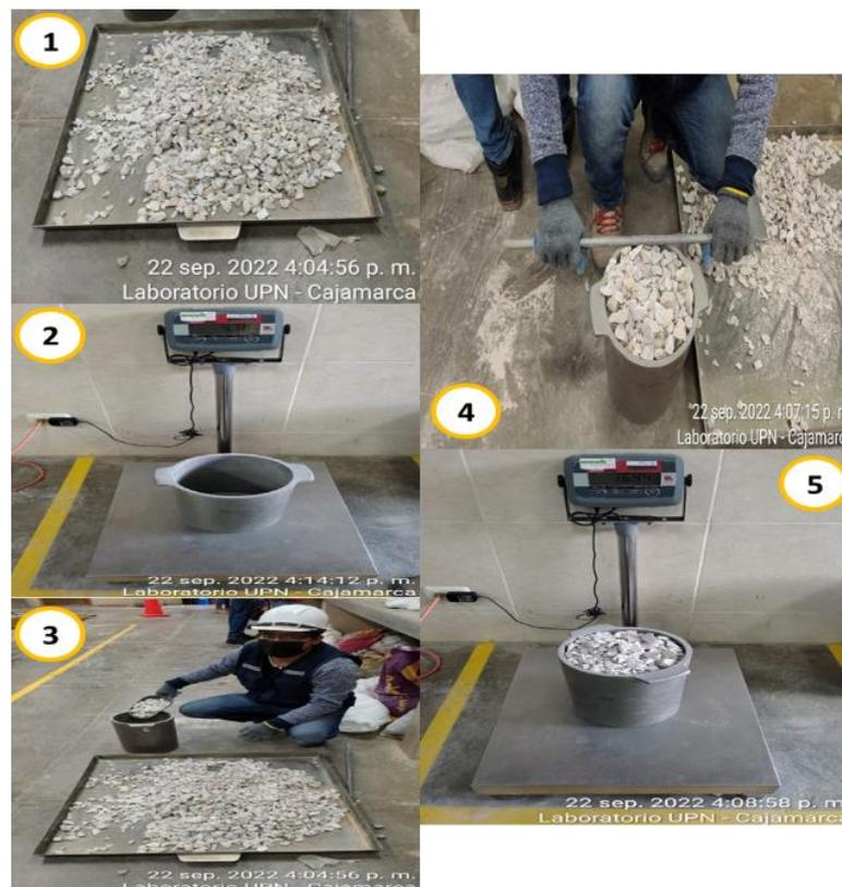
*Nota:* (1) Se deposita en una bandeja metálica el material a ensayar (previamente secar la muestra a temperatura constante). (2) Determinar el peso del recipiente cilíndrico de metal con asas. (3) Llenar el recipiente con la ayuda de un cucharón, hasta el rebose (unos 5 cm por encima del borde del recipiente). (4) Luego enrasar con la varilla de apisonado. (5) Determinar y registrar el peso del recipiente más la muestra.
