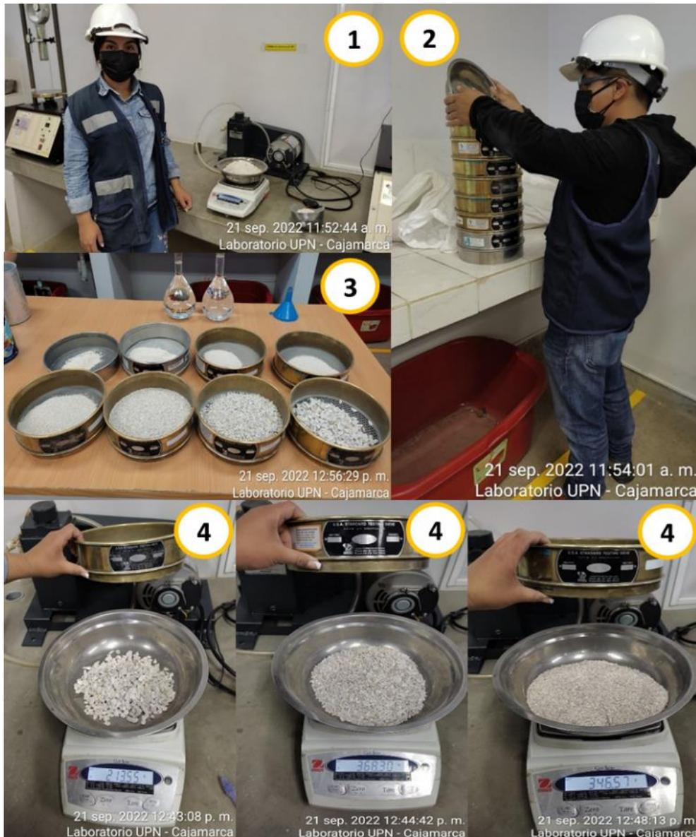
*Nota:* Se determinó y registró el peso de la muestra (1500 gr). (2) Se procedió a vaciar el agregado sobre el primer tamiz, éste se encuentra superpuesto en orden a los demás tamices (N°4, N°8, N°16, N°30, N°50, N°100, N°200, bandeja), se agitó los tamices manualmente a fin de lograr el retenido para cada uno. (3) En la fotografía se aprecia el retenido para cada tamiz y bandeja. (4) Se procedió a pesar y registrar el peso retenido para cada tamiz.
