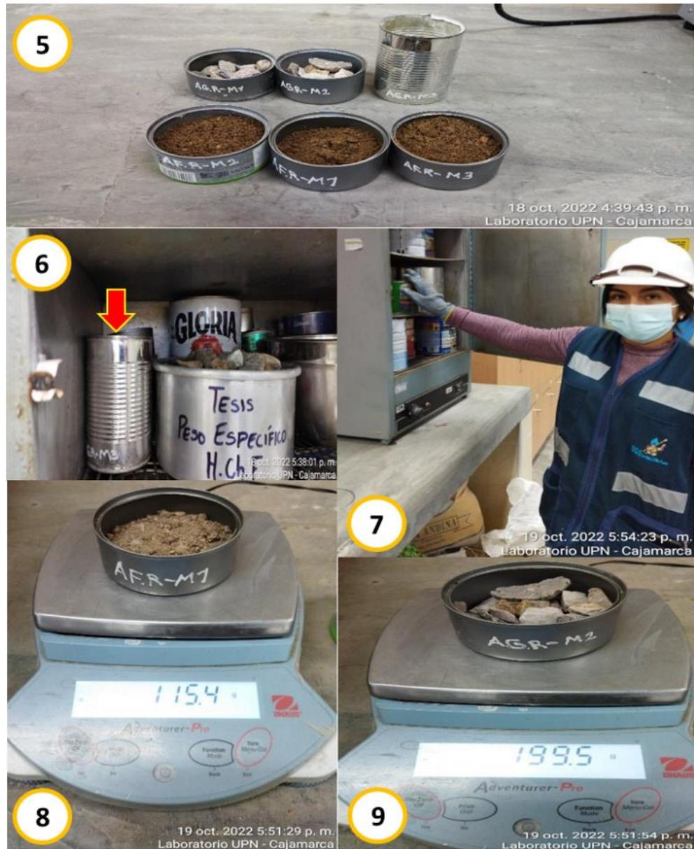
*Nota:* (5) Muestras de agregado fino y grueso. (6) Todas las muestras son colocadas en el horno a temperatura constante por 24 h. (7) Pasada las 24 h se retiran las muestras del horno (8) Se registra el peso de las muestras, en la fotografía se aprecia el Agregado Fino de Río- Muestra 1. (9) Fotografía del Agregado Grueso de Río - Muestra 1.
