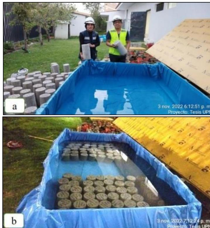
*Nota. a) Colocación de probetas en tina de curado. b) Curado de probetas cilíndricas separadas por tipo de agregado (Río y Roca Volcánica).*
