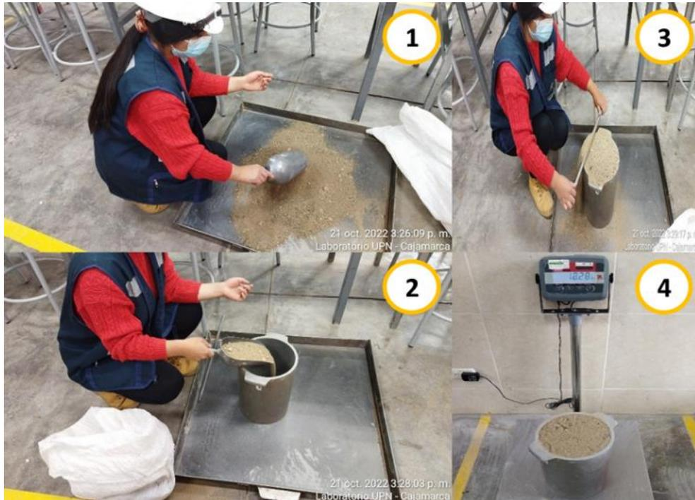
*Nota:* (1) Previamente secar la muestra a temperatura constante y determinar el peso del recipiente cilíndrico de metal con asas, además de medir la altura y diámetro. Colocar en una bandeja el agregado. (2) Llenar el recipiente con la ayuda de un cucharón, hasta el rebose (unos 5 cm por encima del borde del recipiente) (3) Luego enrasar con la varilla de apisonado. Determinar y registrar el peso del recipiente más la muestra. (4) Peso de la muestra 1 más recipiente.
