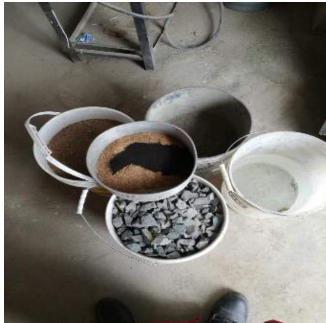
Figura 67. Materiales para la mezcla con adición de cascara de maní y polvillo de aluminio
