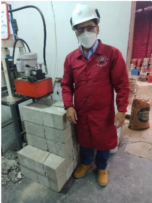
Figura 84. Especímenes luego de las pruebas de resistencia a la compresión y flexión
