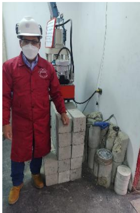
Figura 83. Especímenes luego de las pruebas de resistencia a la compresión y flexión
