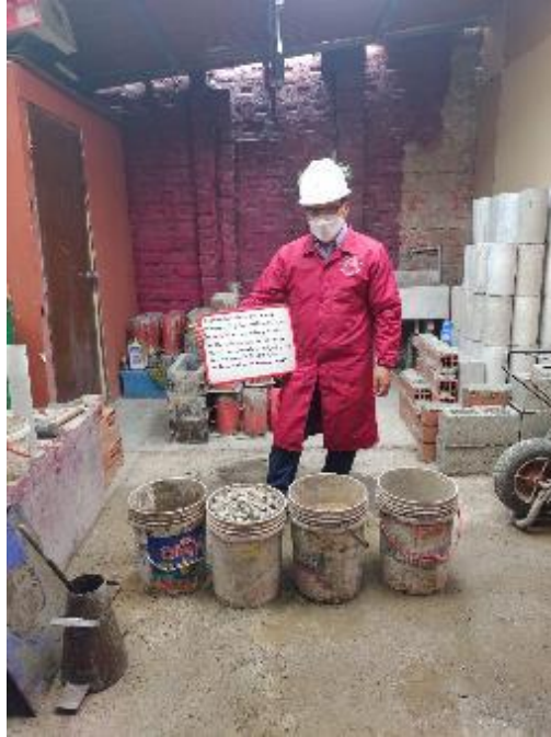
Figura 68. Materiales para la mezcla con adición de cascara de maní y polvillo de aluminio
