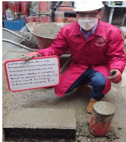
Figura 75. Elaboración de probetas cilíndricas y prismáticas
