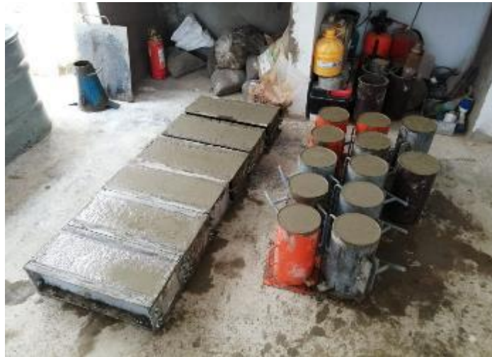
Figura 19. Elaboración de probetas cilíndricas y prismáticas
