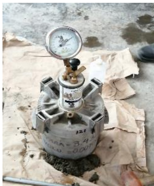
Figura 71. Prueba de contenido de aire
