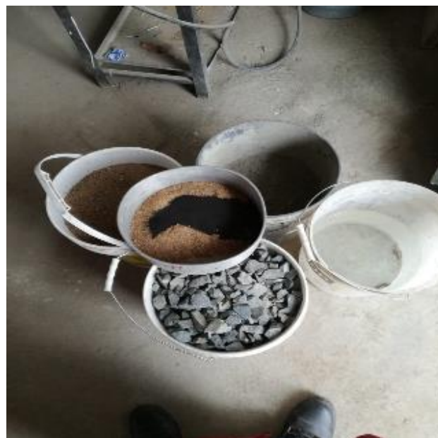
Figura 15. Materiales para la mezcla con adición de cascara de maní y polvillo de aluminio
