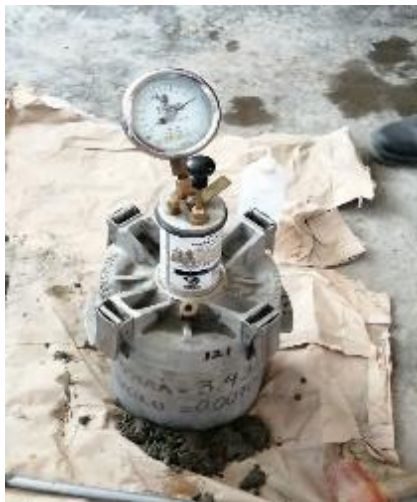
Figura 18. Prueba de contenido de aire
