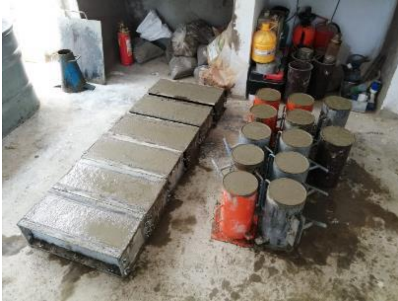
Figura 76. Elaboración de probetas cilíndricas y prismáticas
