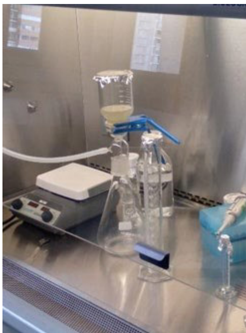
Figura 5. Ensamblaje del sistema para la filtración de muestras de agua residual. “Guía instructiva para la detección del SARS-CoV-2 en agua residual” (HELVETAS PERU, 2021)
