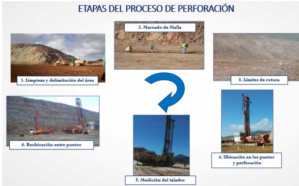
**Figura 7** *Etapas del proceso de perforación.*
