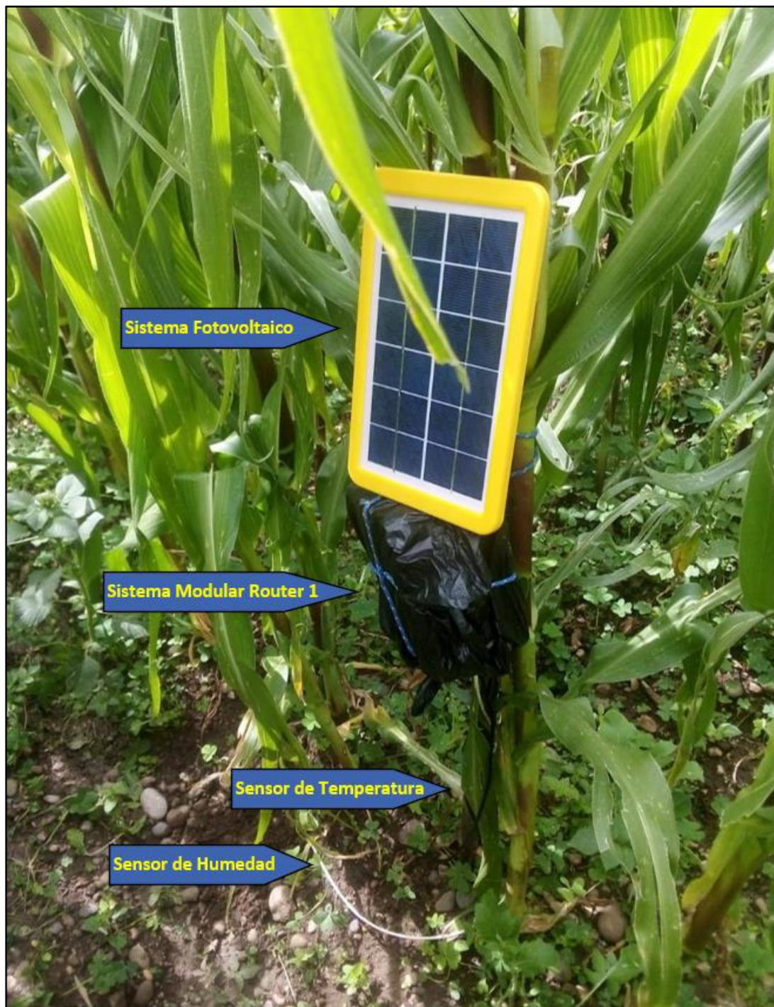
**Figura 56. Instalación individual de los módulos Router 1-2-3.**
