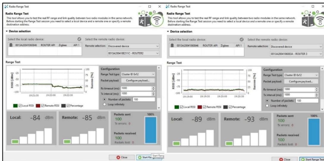
**Figura 74. Prueba de cobertura entre Router API y Router 2-3.**
