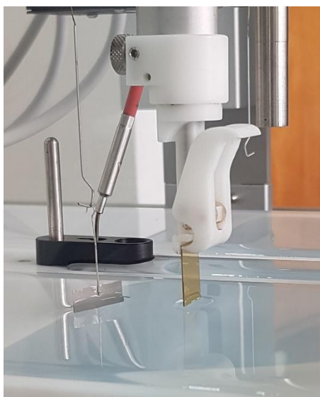
Figura 3.3. Configuración experimental del proceso de transferencia por dip-coating de monocapas de GO sobre sustratos sólidos (en la imagen: vidrio/Au)
