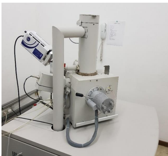
Figura 2.4. Microscopio electrónico de Barrido (SEM, por sus siglas en inglés), FEI QUANTA 200, perteneciente al LIMF, FI, UNLP.
