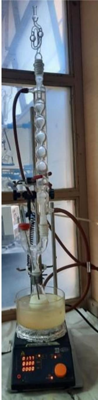
**Figura 3.h** Equipo utilizado para la síntesis de las dispersiones poliméricas.
