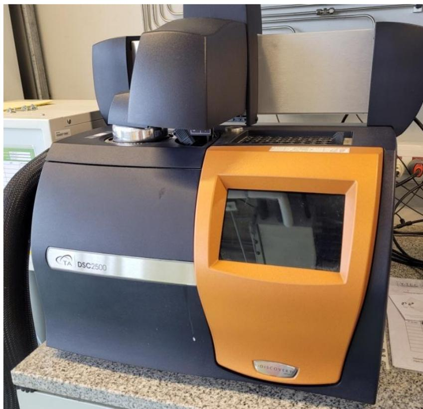
**Figura 4.n** Equipo TA 2500 para el análisis de DSC utilizado (gentileza YTEC).
