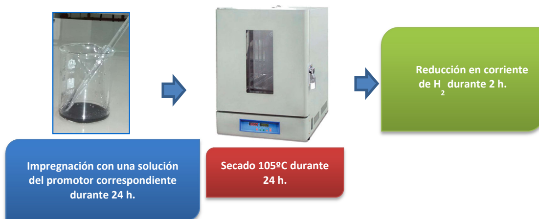
Figura 4.4 Esquema general de preparación de la serie de catalizadores bimetalicos por impregnación.
