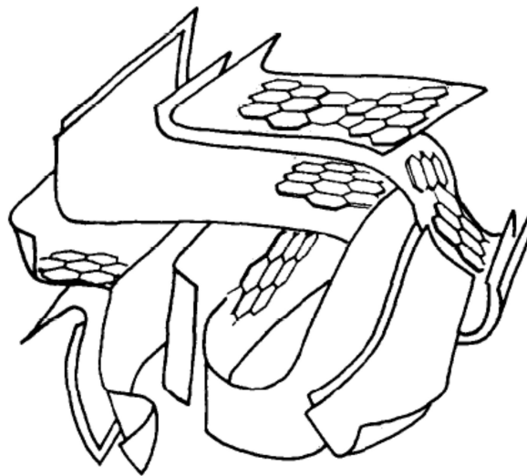
Figura 3.4. Representación esquemática de la estructura del carbón activado (Stoeckli, H. F., 1990).
