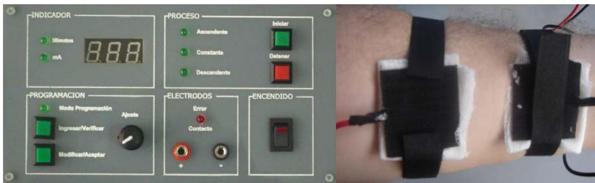
**Figura1.** Panel frontal y modo de sujeción de electrodos
