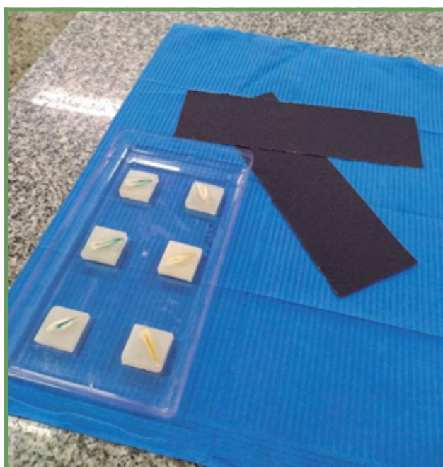
Figura 3: Muestras preparadas para el pulido con lijas 150, 240 y 280.
