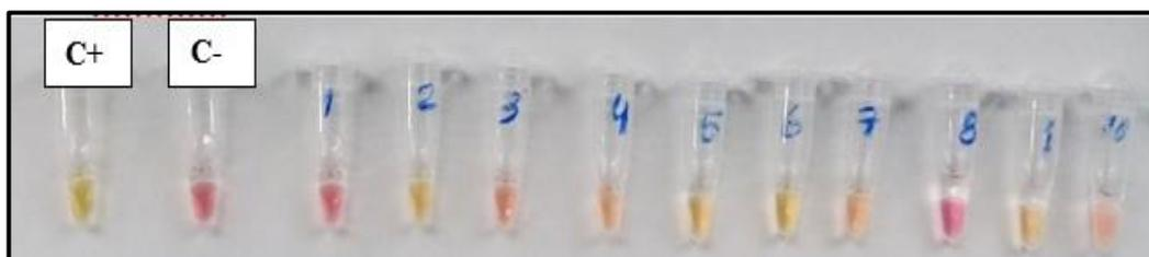
Figura 28. Prueba de LAMP. Observar el control positivo en amarillo y en rosa el control negativo. Del 1 a las 10 son muestras. Las número 1 y 8 se consideran negativas. Las muestras 2, 3, 4, 5, 6, 7, 9 y 10 son positivas. Nótese que mediante este sistema de revelado que se basa en el cambio de pH se obtienen una serie de colores intermedios que hacen compleja la interpretación del resultado.
