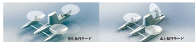
写真-1 水域の深浅測量機器を搭載した水・空航行ドローン (As-1)
