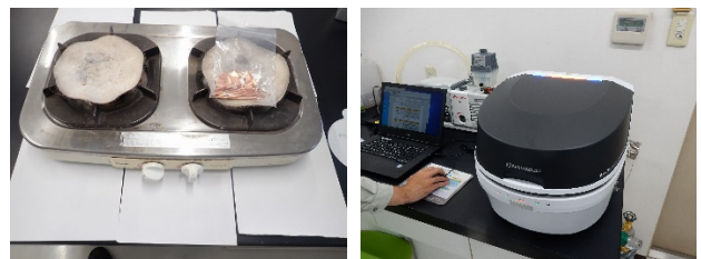
図-4 ハロゲン含有の判別 （左：パイルシュタイン試験、右：蛍光 ED-X 装置）
