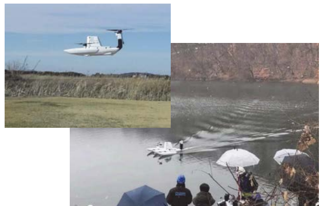
写真-1 水域の深浅測量機器を搭載した水・空航行ドローン (As-1)
