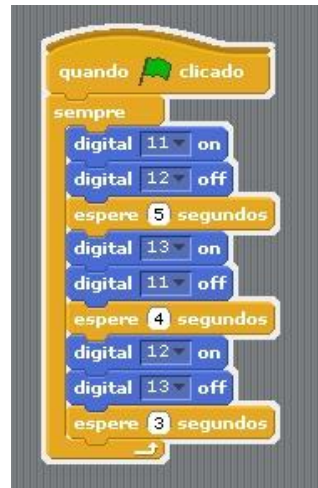
Figura 1: Programação do semáforo feita pelos três estudantes no software S4A
