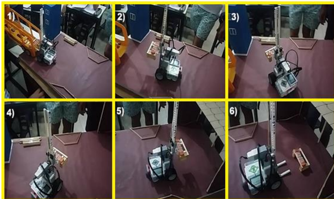
Figura 6– Robô Empilhadeira descarregando objetos de uma suposta “carreta” no mundo inventivo
