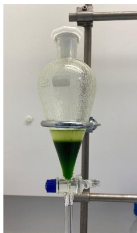
Figura 2.2 - Extração lipídica através do método Bligh & Dyer.
