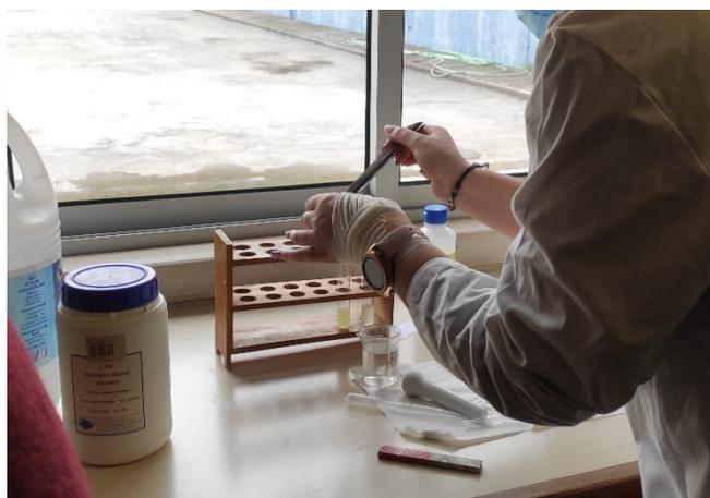
(Registo fotográfico 7 – adição do sulfato de sódio anidro para secagem do biodiesel)
