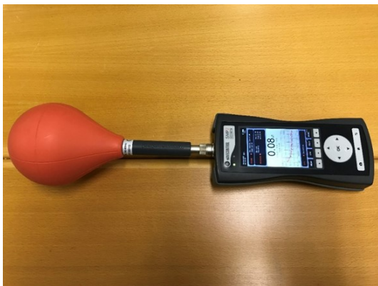
Kuva 5. Pientaajuisen sähkö- ja magneettikentän mittari Wavecontrol SMP2 ja mittapää WP400.
