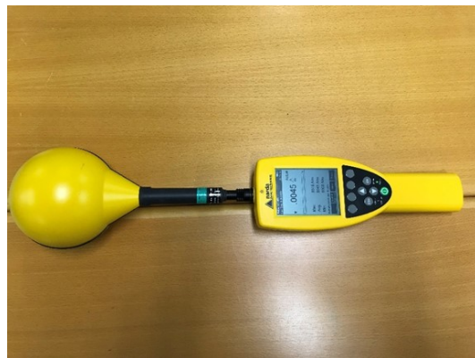
Kuva 6. Radiotaajuisen sähkö- ja magneettikentän mittari Narda NBM-550 ja mittapää HF3061.
