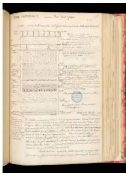
Figure 12 - Coupe géologique du boulevard Haussmann (Paris) réalisée par Théodore Vacquer, architecte du XIXe siècle © Avinain, 2022
