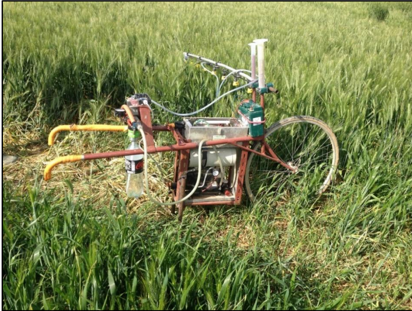
Photo 1 : Pulvérisateur expérimental utilisé pour l'apport de biostimulants et d'azote foliaire au champ
