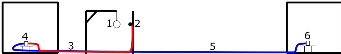
Figure 3-3: Disposition des différents éléments nécessaires pour une mesure de surpression aérienne à symétrie sphérique et en champ libre avec le standard IEPE.
