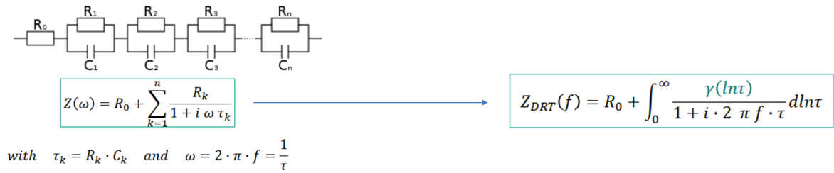
FIGURE A.14 – Fonction qui permet de réaliser l’analyse DRT, figure issue de [Sch16]..
