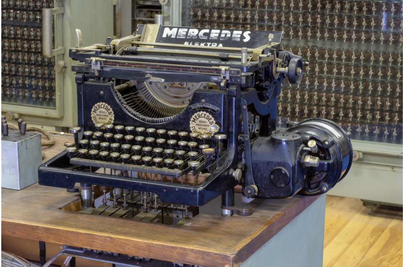
A MESZ I kimeneti egysége, egy átalakított elektromos írógép
