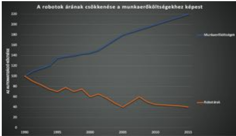
5. ábra: A robotok árának csökkenése a munkaerőköltségekhez képest*
