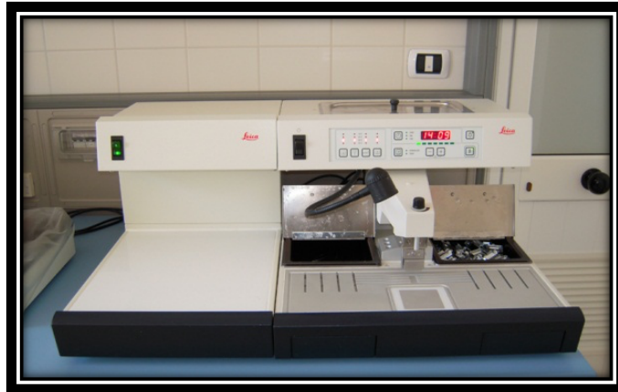
Figura 6 Piastra raffreddante (sinistra) e dispensatore di paraffina (a destra)
