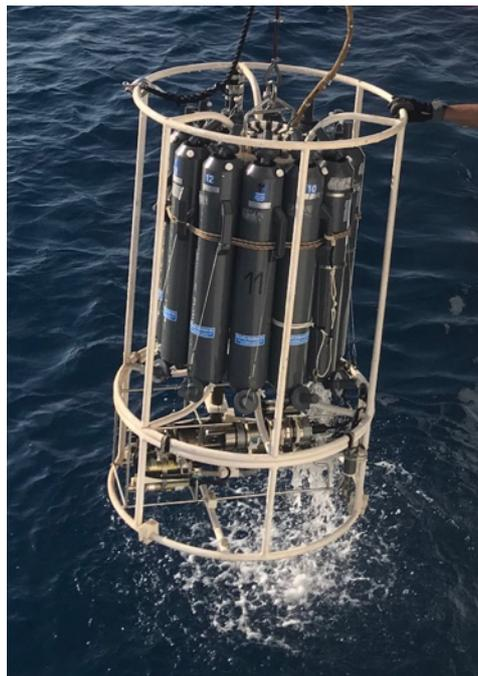
*Figura 2 Rosetta con sonda CTD e bottiglie Niskin*
