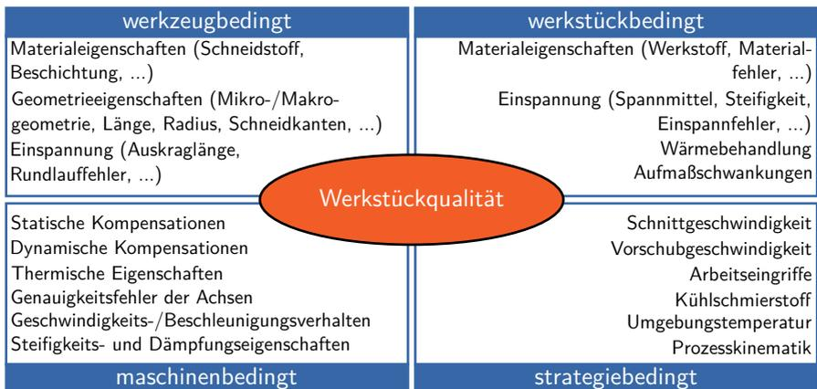
Abbildung 5.14: Einflussfaktoren auf die Werkstückqualität.
