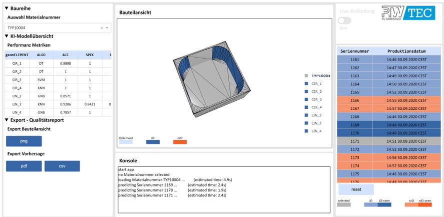
Abbildung A.4: Bauteil „TYP10004“ (Tiefe Tasche) - Qualitätsrelevante Flächen nach Prognose.
