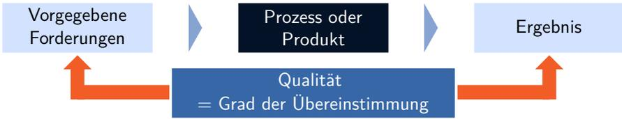
Abbildung 2.10: Qualität als Grad der Übereinstimmung zwischen vorgegebenen Forderungen und dem Ergebnis, angelehnt an [BRÜG20].
