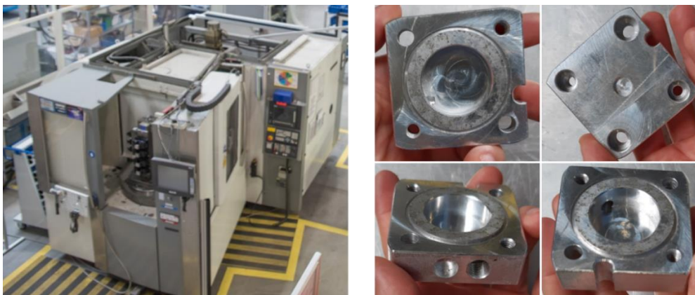
Abbildung 22: links: Horizontal-Bearbeitungszentrum Deckel Maho DMC 50H am Standort Prozesslernfabrik CiP der TU Darmstadt (Bild: Sybille Scheibner, PTW); rechts: Endprodukt des untersuchten Fräsprozesses – Zylinderboden eines Pneumatik-Kompaktzylinders (Bild: Julia Zeulner)
