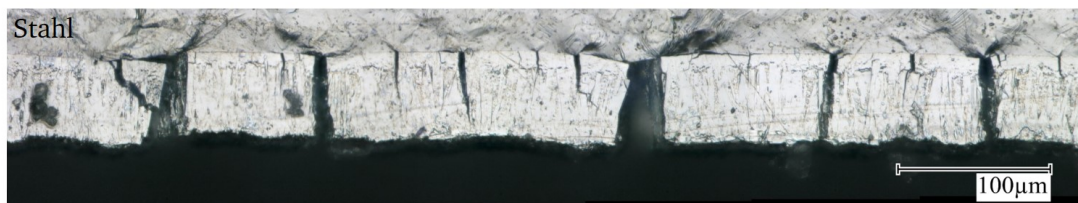
Abbildung 6.5: Exemplarische Darstellung der Segmentierungsrisse im Zinküberzug während eines Mikrozugversuchs
