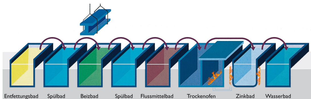
Abbildung 2.8: Schematische Darstellung des Trockenverzinkens von Stückgut [39]
