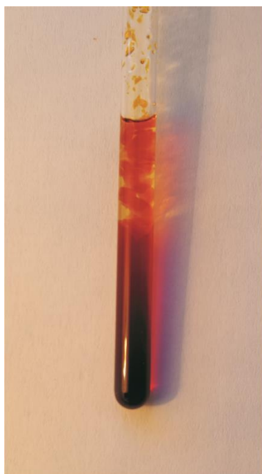
Abbildung 24: Fertig gequollener Stick 6 in \text{CDCl}_3 mit abgeplatzter oberer Lage. Rechts: zugehöriges ^2\text{H} -Image.
