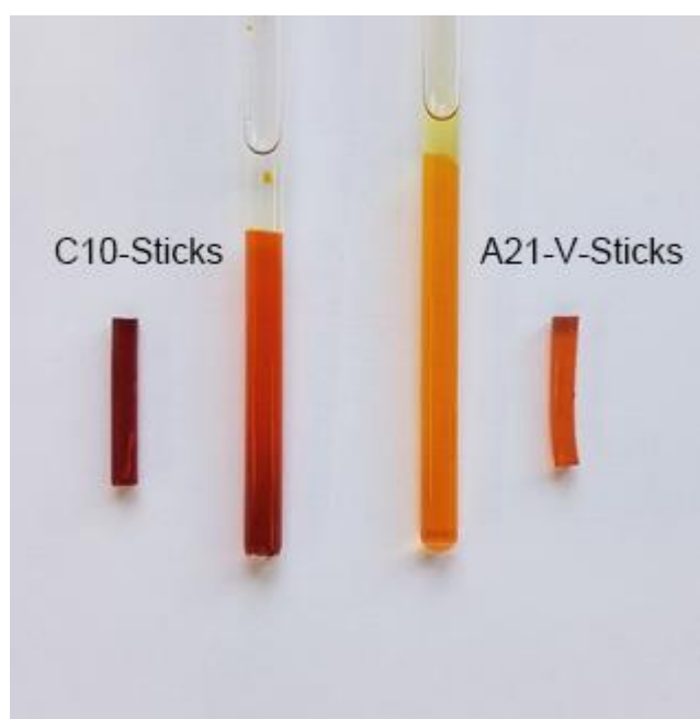
Abbildung 41: Vergleich von reinen PPA- und PPA/PDMS-Copolymersticks vor und nach der Quellung. Links: L-ValDecyl/C10. Rechts: L-ValDecyl/A21-V. Alle vier Sticks haben eine Zusammensetzung von x(V)=0.1 und w%(M)=25 ; gleich wie Stick 43 (C10) bzw. Stick 95 (A21-V)
