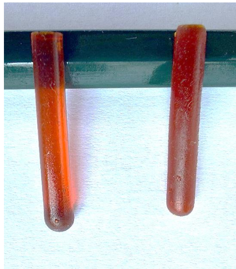
Abbildung 110: Zwei L-ValSulfon-basierte Gele. Links: klarer Stick mit P4K-V ; Rechts: trüber Stick mit P8K-V .
