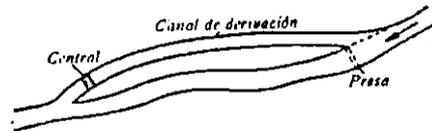
Fig. 1.10 Representación esquemática de una central de agua corriente con canal de derivación.
