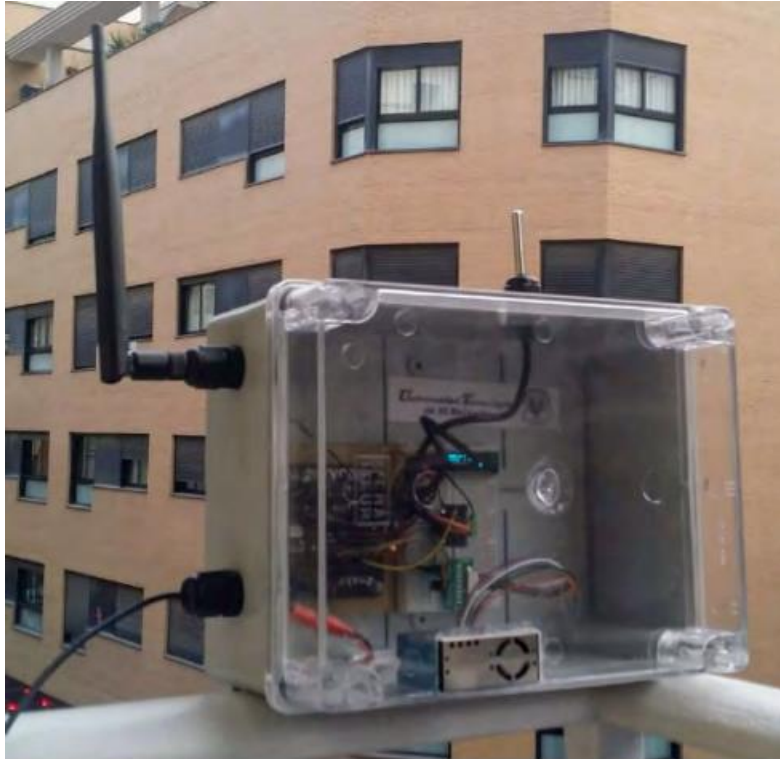
Ilustración 9. Estación IoT monitoreando la calidad del aire en exteriores (Flores, 2019).
