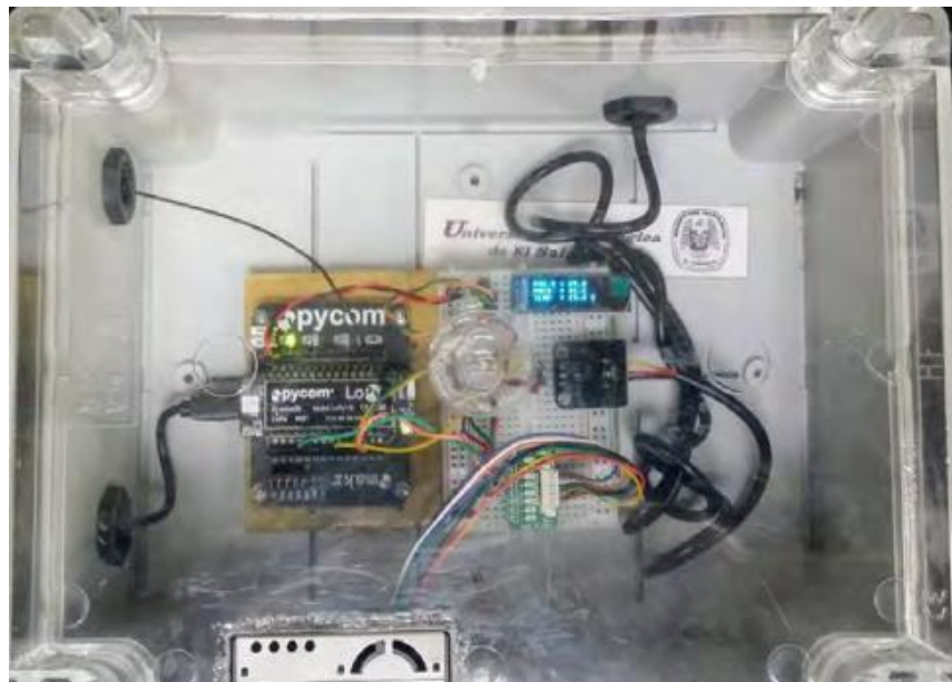
Ilustración 8. Dispositivo de bajo costo para el monitoreo de la calidad del aire (Flores, 2019).
