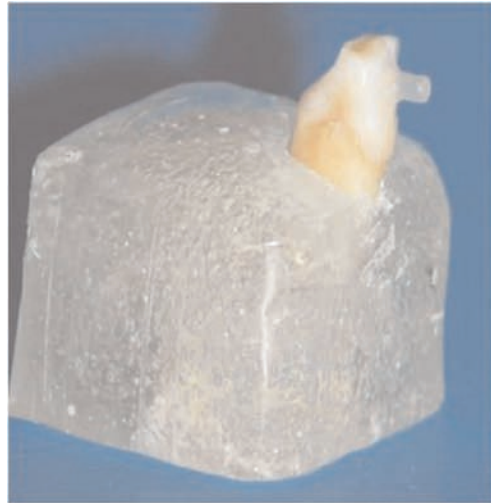
Şekil 2: Bağlanım dayanım testi için hazırlanmış bir örnek
