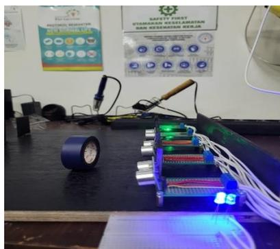
**Gambar 4.3** Kondisi ketika Sensor Ultrasonik 2 Aktif
