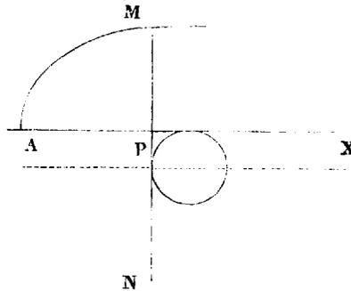
Pour cela, il suffirait d'avoir d'abord une règle  $AMX$  dont un côté  $AX$  serait droit et l'autre  $AM$  formerait la courbe dont  $\varphi(x) - r$  serait l'ordonnée,  $r$  étant le rayon du cylindre. Ensuite, on ferait tourner le cylindre en appliquant contre sa base la règle  $AX$ . Si le fil qui s'enroule reste dans le plan vertical  $PM$ , ce
