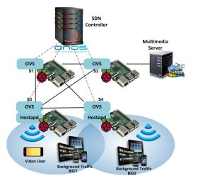
Fig. 3. Experimental Test-Bed Setup
