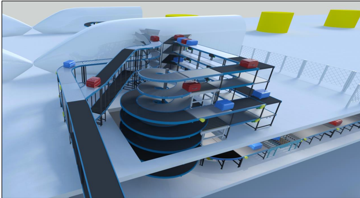
Abbildung 33: Weiche, Förderung auf den Bahnsteig, Pufferregale und Entladeanlagen auf einer Zugseite
