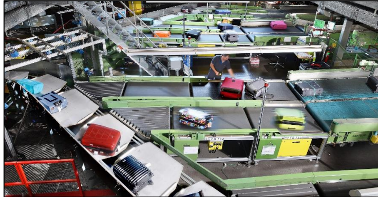
Abbildung 14: Behälterlose Gepäckförderung am Flughafen Zürich (Quelle: Flughafen Zürich, 2023)
