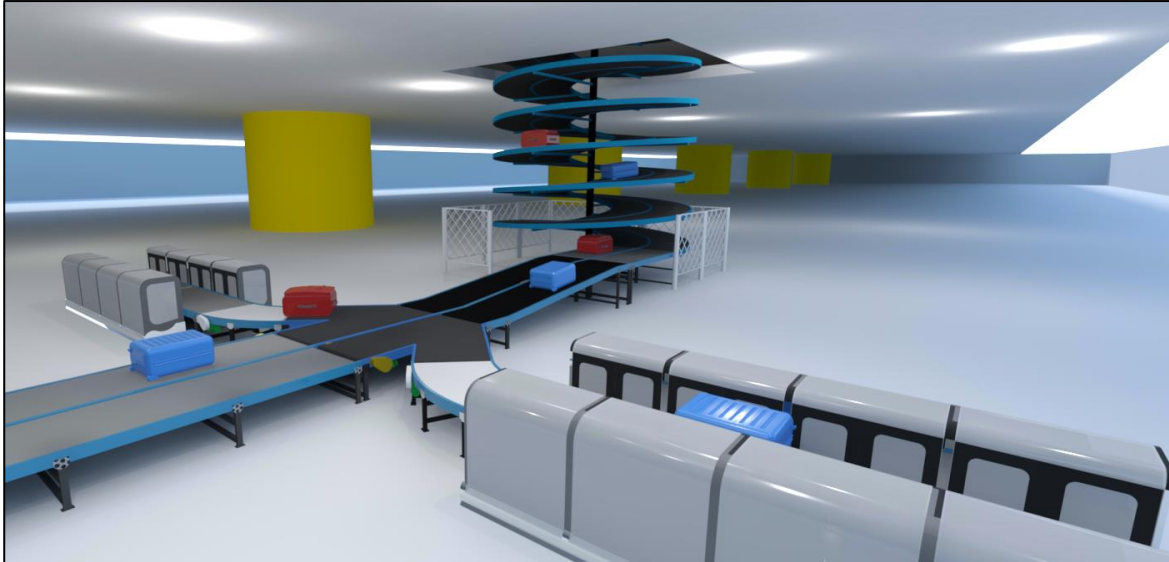
Abbildung 30: Gepäckaufgabe und Vertikalförderung in die Sortierebene
