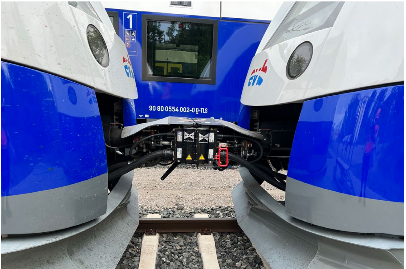
Detailausschnitt der gekuppelten SchaKu Typ 10
