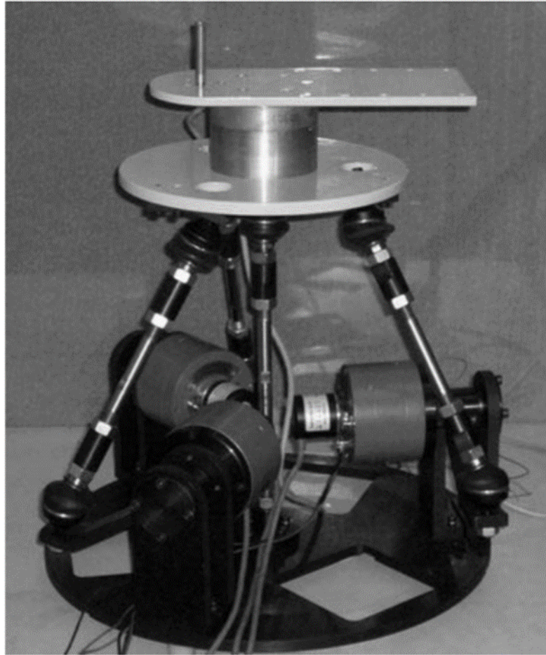
Figura 1.11: 3-RSS/S Robot de rehabilitación de tobillo tipo plataforma Stewart [14].
