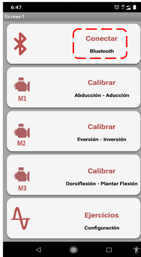
Figura 4.7: Interfaz de aplicación móvil para control de trayectorias en órtesis de tobillo.
