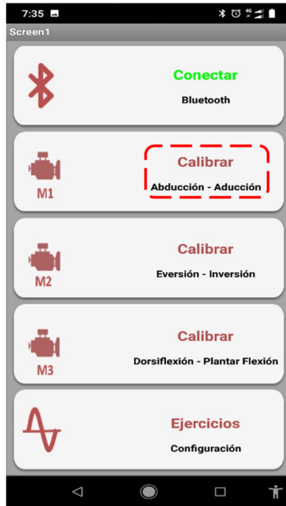
Figura 4.12: Procedimiento para acceder a la ventana de calibración de cada motor.
