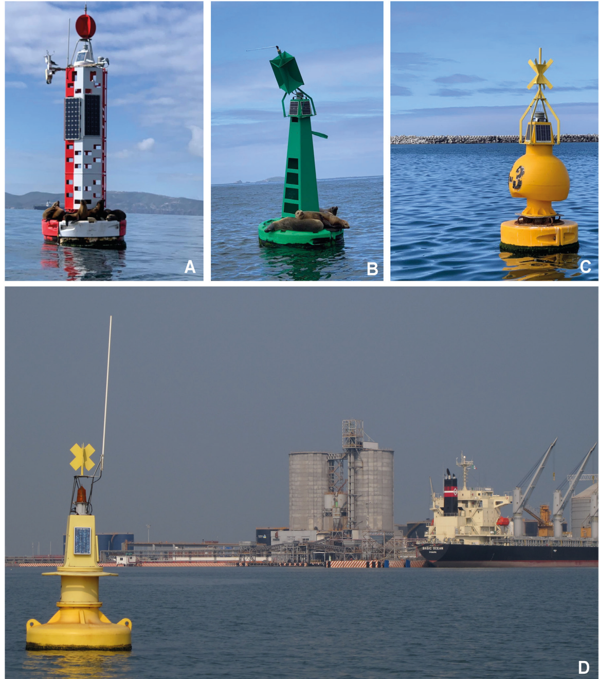
Figura 5. Boyas de señalamiento marítimo en puertos de altura y cabotaje. Fotos: A-C) Victoria Diaz-Castañeda, D) Humberto Bahena-Basave.
