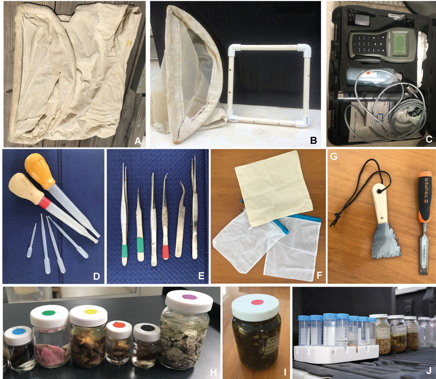
Figura 2. Materiales de muestreo y frascos. A) Bastidor con bolsa recolectora, B) bastidor y marco cuadrado, C) sonda multiparamétrica. D) pipetas plásticas, E) pinzas de campo, F) bolsas recolectoras de muestras, G) espátula y formón, H-J) frascos y viales para el almacenamiento de muestras. Fotos: A-I) María Ana Tovar-Hernández, J) Angel de León-González.
