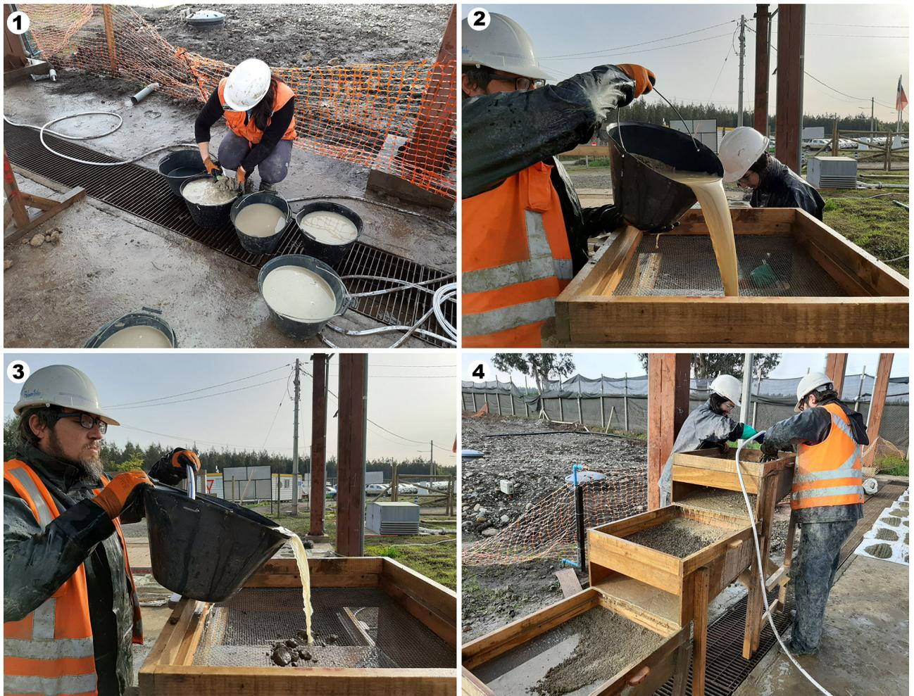
**Figura 10.** Proceso de tamizaje. 1, Revisión del sedimento depositado en baldes de forma manual; 2–3, Vertido lento y flotación por medio de presión del agua a través de manguera; 4, Sedimento vertido en tamices, seleccionándose granulométricamente.
